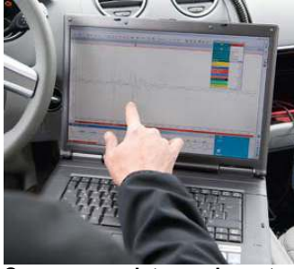
Sensoren registreren hoe sterk schokken bij het rijden over de hindernis op de trailer inwerken.
